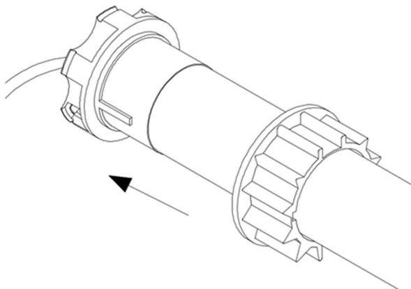
d) Puis faites glisser le toc sur le corps du moteur jusqu'à l'extrémité avec les saillies - en insérant la saillie dans la rainure du toc (la version avec commande de secours a un toc en métal).
