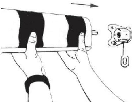
16) Insérez le store avec un tige ronde et un palier lisse dans la deuxième fixation et verrouillez le palier avec une vis Allen.
