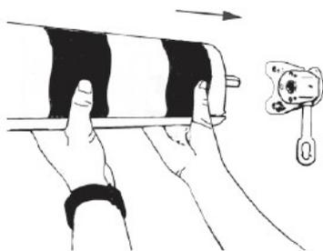
8) Placez le palier lisse en plastique à l'extrémité du tube d'enroulement avec un tige ronde.
