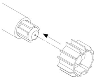
e) Insérez complètement le moteur par côté de toc dans le tube d'enroulement.
