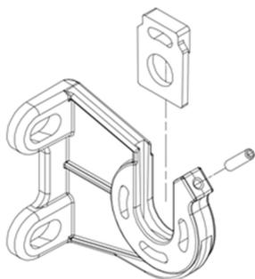
c) Glissez la bague adaptatrice en plastique sur le corps du moteur par le côté sans câble (avec le disque périphérique vers le câble jusqu'à ce que la rainure de l'adaptateur s'enclenche dans la saillie métallique du corps du moteur).
