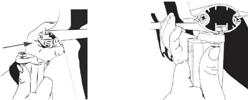
19) Commencez l'installation des bras par marquer les endroits de fixation des supports.
